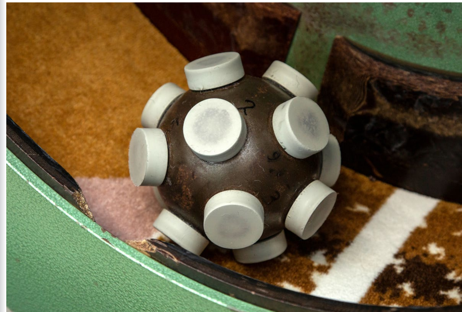
Abb. 43: Stahlkugel mit Gummistempeln in Vettermann-Trommel
