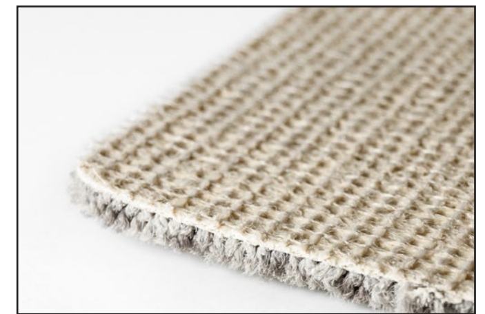
Abb. 13: Warenrückseite, Zweitrücken aus Gewebe
