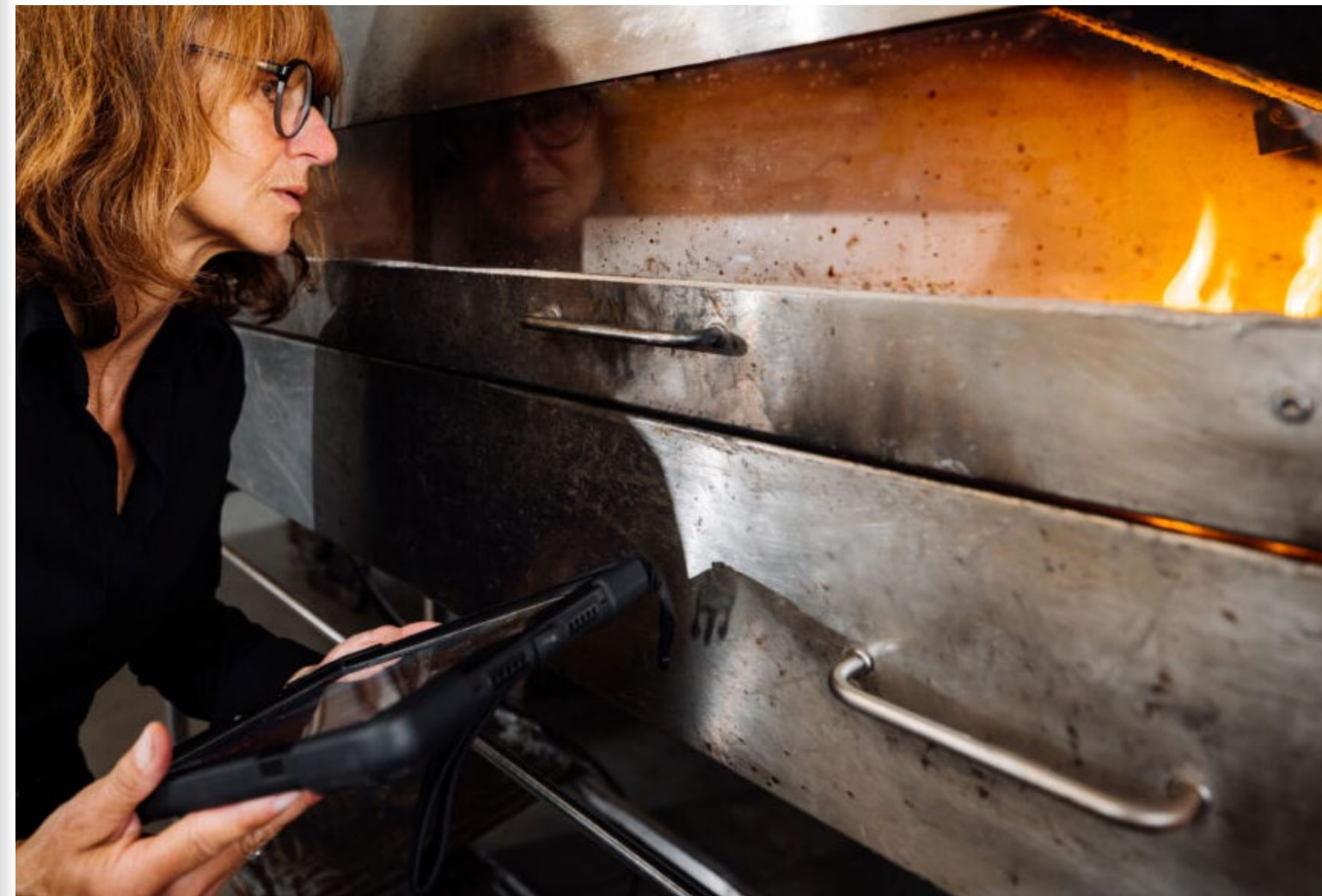
Abb. 65: Protokollierung des Brandverlaufs in der „Radiant Panel“-Prüfkammer; Quelle: TFI Aachen
