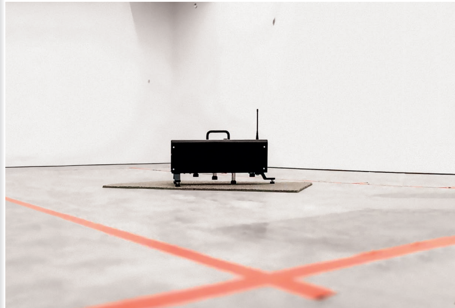
Abb. 59: Hammerwerk im oberen Prüfraum bei Trittschalltest; Quelle: TFI Aachen
