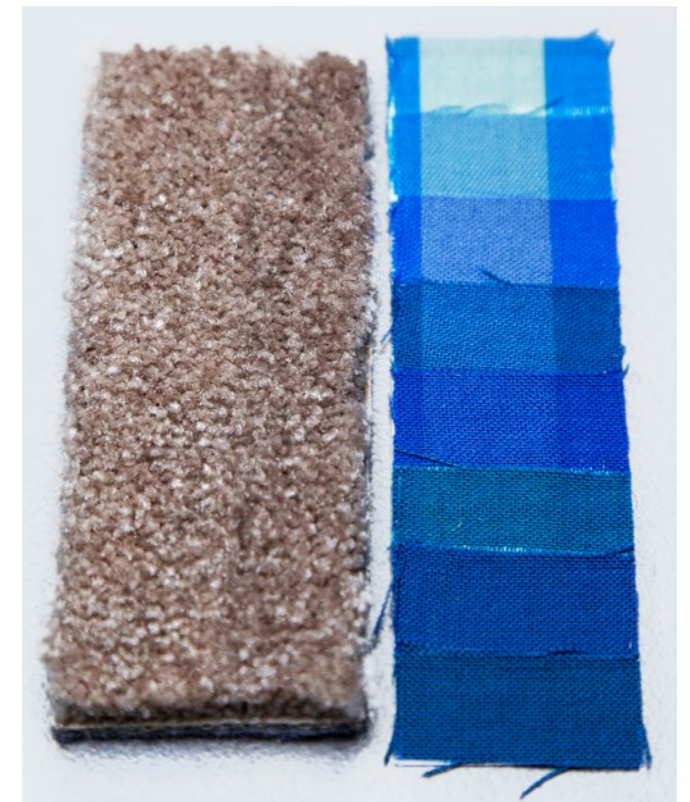
Abb. 41: Prüfling und Blaumaßstab nach Belichtung
