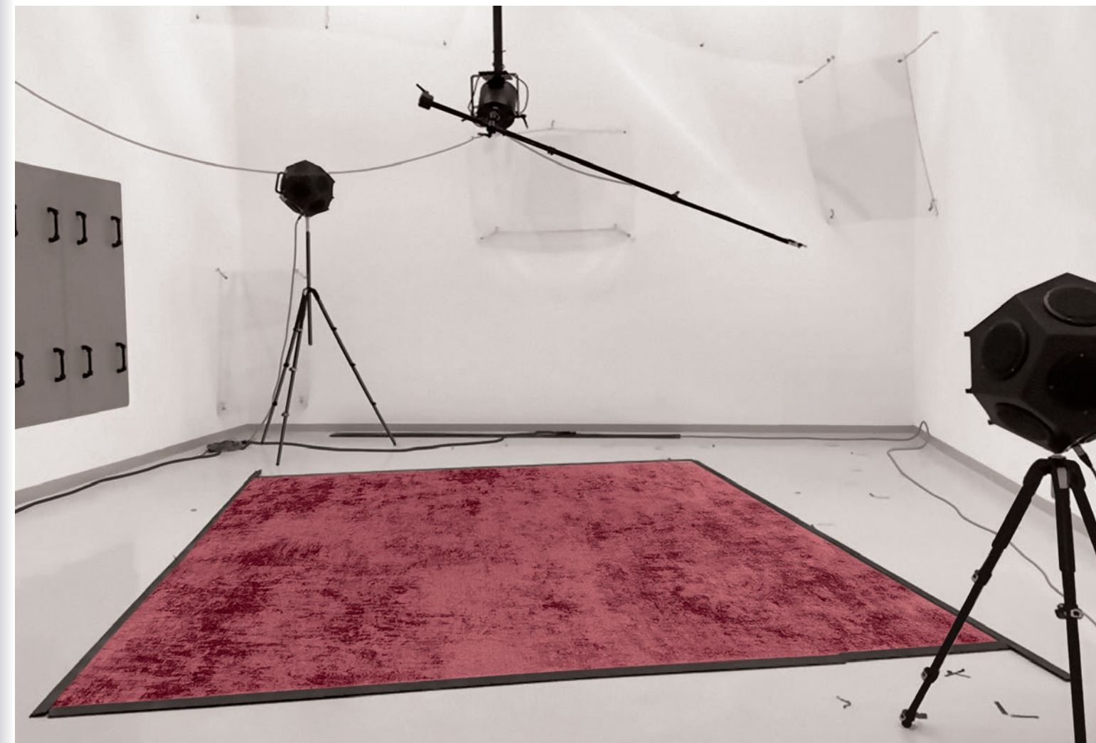
Abb. 61: Hallraum des TFI mit Lautsprechern, Mikrofon, Diffusoren und Prüfling; Quelle: TFI Aachen
