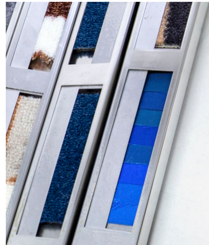
Abb. 40: Prüflinge und Blaumaßstab vor Belichtung
